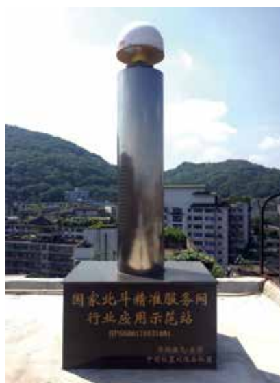
北斗地面差分站（宜宾华润燃气）
